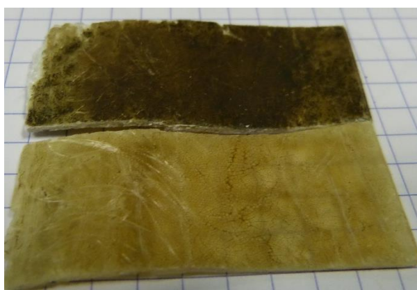
Figure 2 : Comparaison de l'échantillon avant nettoyage (en haut) et après nettoyage (en bas)
